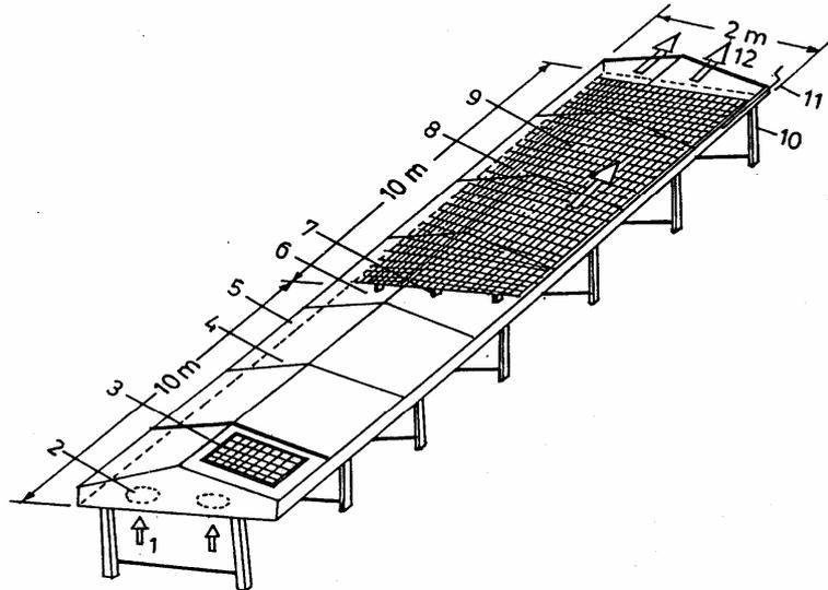
Fig. 4. Solar tunnel drier.
